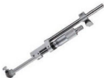
La stimulation électrophysiologique ou l'enregistrement d'expériences nécessitent une précision critique de la manipulation d'électrode. Ce micro-entraînement améliore la précision opérationnelle dans le sens vertical jusqu'à 10  $\mu\text{m}$ . Il est facile à manipuler, et divers supports d'électrode sont disponibles pour fonctionner avec le micro-entraînement.
