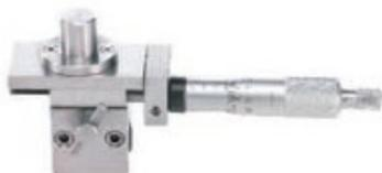
Le réglage de ce micro-entraînement peut être affiné dans une plage de 25 mm avec des échelons de 10  $\mu$ m. Cela rend le travail avec le manipulateur sur l'instrument stéréotaxique encore plus précis.
