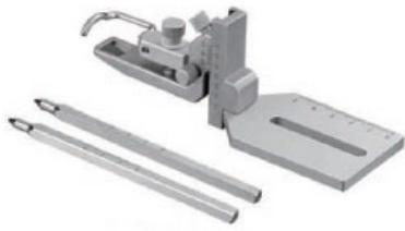
L'adaptateur pour petit oiseau utilise des barres d'oreille à 45° et une pince incurvée pour bec pour fixer la tête de l'animal. Il peut être ajusté dans les deux directions verticale et horizontale.
