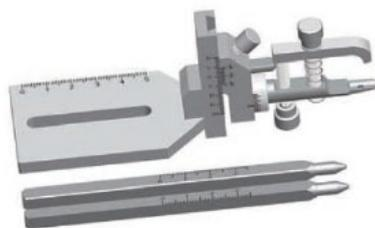
Cet adaptateur maintient la tête de l'animal à l'aide d'une barre de palais et d'une barre de gueule. Il offre un réglage vertical qui permet d'adapter le niveau de la tête sous une inclinaison particulière. Réglage vertical de 30 mm (+10 mm ~ -20 mm) avec incréments de 0,1 mm, réglage de course A/P de 43,5 mm, réglage coronal de 35°.
