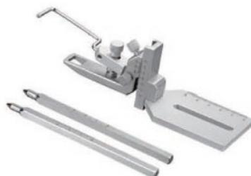
Cet adaptateur maintient la tête au moyen de barres d'oreille à 45°, d'une pièce de maintien des incisives et d'une barre de gueule. Pour maintenir des cobayes de différents poids, la barre de gueule dispose d'un intervalle de réglage de 30 mm le long d'une glissière à queue d'aronde verticale, et d'un intervalle de réglage de 50 mm dans le sens horizontal.
