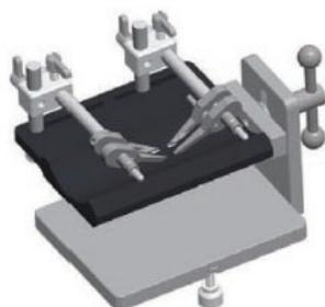
Cet adaptateur pour moelle épinière peut être utilisé pour l'étude de la souris. Durant l'expérience, les souris peuvent être soulevées pour éviter tout impact sur la respiration. Il est possible de faire pivoter cet adaptateur sous différents angles en fonction de la hauteur du socle, afin de faciliter l'observation au microscope. Le socle peut également être fixé facilement à la platine du microscope par des vis en T.
