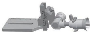
Cet adaptateur intègre la fonction de masque pour anesthésie gazeuse tout en maintenant fermement la tête du rat. L'adaptateur permet de faire pivoter la tête sous de multiples angles sans bloquer l'alimentation en gaz anesthésiant.
