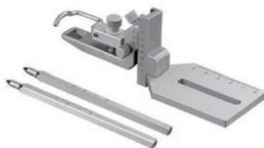
Cet adaptateur fait partie de l'équipement standard des instruments stéréotaxique. Il maintient fermement le cerveau du rat par une pièce de maintien des incisives, un pince-museau et une paire de barres d'oreille. Il est doté d'un intervalle de réglage vertical de 30 mm d'une précision de 100  $\mu\text{m}$  le long de la glissière à queue d'aronde, et d'un intervalle horizontal de 50 mm, ce qui permet de fixer des rats de poids variés.
