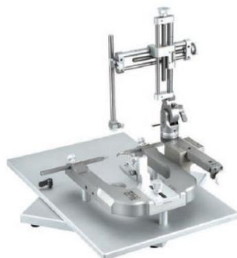
Toutes les fonctionnalités d'un instrument stéréotaxique standard, mais un socle rotatif pour les procédures chirurgicales sous différents angles. Les pièces rotatives assurent une rotation flexible et durable sur l'ensemble de la plage de 360°. Les chercheurs peuvent verrouiller l'instrument tous les 45°.
